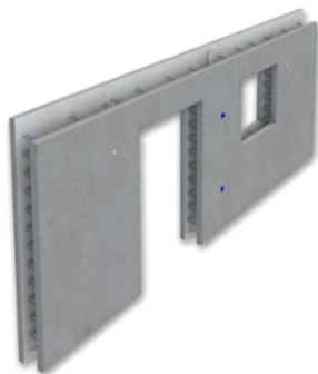
Figura 2.6 – Exemplo ilustrativo de parede dupla com aberturas, adaptado de [20].
