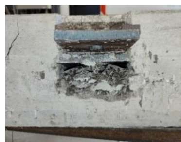
Figura 11 Resultados ao corte para fora-do-plano: (a)força-deslocamento; e modo de rotura: (b) Connection-1; (c) Connection-2; (d) Connection-3
