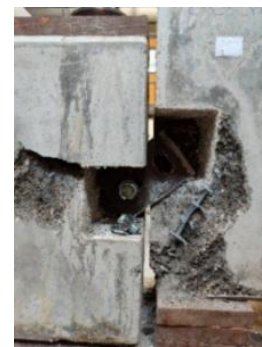
Figura 10. Resultados ao corte no plano; (a) Força-deslocamento; and e modo de rotura: (b) Connection-1; (c) Connection-2; (d) Connection-3
