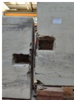
Figura 10. Resultados ao corte no plano; (a) Força-deslocamento; and e modo de rotura: (b) Connection-1; (c) Connection-2; (d) Connection-3
