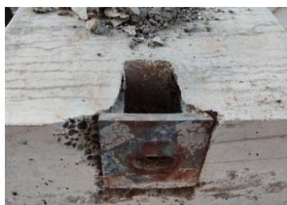
Figura 11 Resultados ao corte para fora-do-plano: (a)força-deslocamento; e modo de rotura: (b) Connection-1; (c) Connection-2; (d) Connection-3
