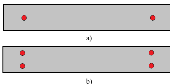
Figura 76 - Influência do número de varões por ligação: a) modelo de referência; b) modelo com dois varões por ligação.
