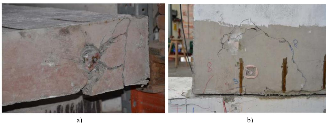
Figura 38 - Danos observados: a) modelo A1D25M-G [10]; b) modelo A1D25C-G [10].
